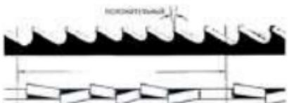
Этот тип пильного полотна больше всего подходит для распила профилей и больших труб с толстыми стенками, а также цельных прутков максимально допустимых для станка размеров. Возможные величины шагов: 3-4/4-6. Развод зубьев Зубья отклоняются от плоскости основания пилы, в результате образуется широкий пропил в заготовке.
