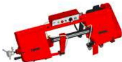
На раме расположен болт с демпфером для фиксации нижнего положения. Для фиксации верхнего положения служит пружина.
