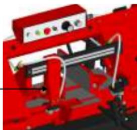
Установите упор для отрезки в налаженный размер, установив упор на ось и зафиксировав ее винтом.
