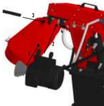
3. Установите приводной ремень. Регулируйте натяжение ремня с помощью кронштейна, меняя наклон двигателя, и затяните винт для фиксации
