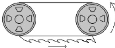
Необходимо произвести выверку пильного полотна экспериментальным путем. Произведите пробный рез и оцените обработанную поверхность. Отрегулируйте кронштейн пильного полотна под размер заготовки, в случае перпендикулярного реза или зарезания тисков отрегулируйте винты крепления и винты установки твердосплавных направляющих:
